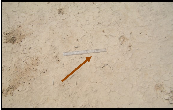
الشكل (8 أ) نمط (1) لشقوق التجفيف في القاع الشكل (8 ب) نمط (2) لشقوق التجفيف في القاع
